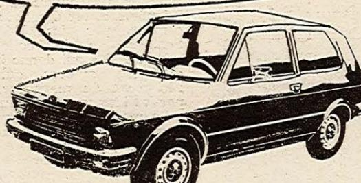
4 CV (900 cm<sup>3</sup>). Traction avant, 4 roues indépendantes. Culasse en alliage léger. Freins à disque à l'avant. Sièges AR rabattables. Hayon. Le tout en 3,49 m.
